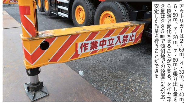
アウトリガーは2.69m、4.30m、5.40m、6.50m、7.20m、7.60mと張り出し量を6段階で変化させることができる。タイヤ浮き量は285mmで傾斜地での設置にも対応。安定した作業を行うことができる
