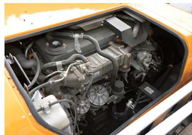
エンジンは総排気量13ℓの日野E13C-VV形直噴ディーゼルインタークーラーターボ。最大出力275kW/1,800rpm、最大トルク1,510N・m/1,300rpmを発揮する。平成23年ディーゼル特殊自動車排出ガス規制に適合
