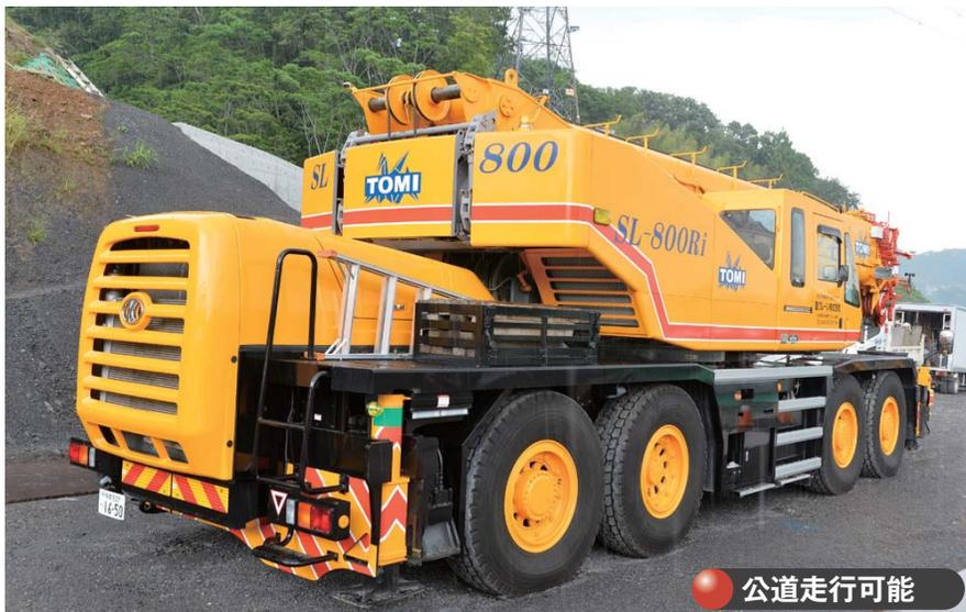
せるほか、最大7.6mまで張り出すことができるアウトリガを備えている。ステアリング方式はリヤステアリング（前後逆位相）、クラブ（前後同位相）が選択することにより、細かな位置決めをすることが可能。
